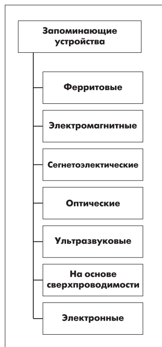
Рис. 1. Упрощенная классификация систем памяти по типу носителя информации
