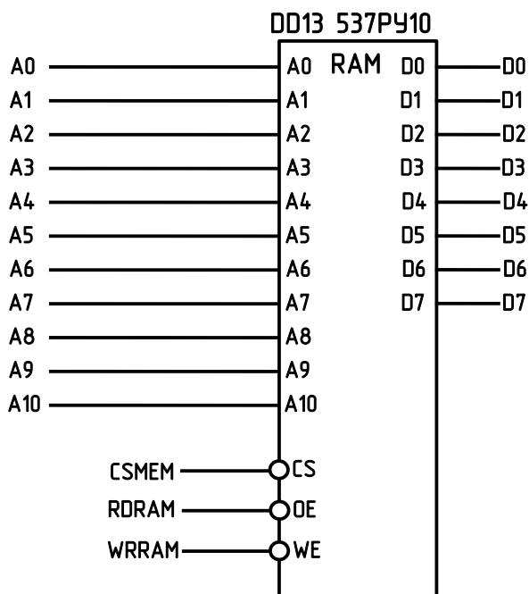
Модуль теневого ОЗУ предназначен для сохранения данных монитора. Теневое ОЗУ имеет размер 2К, достаточный для сохранения всех регистров процессора и других данных для восстановления контекста прерванной программы.
