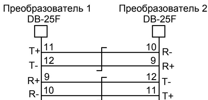
**8. Схема 4-проводного кабеля (две витые пары) для соединения преобразователей с адаптером "A8-CL20 APS R3" и терминальным контроллером "TK-380M" по интерфейсу CL20mA.**
